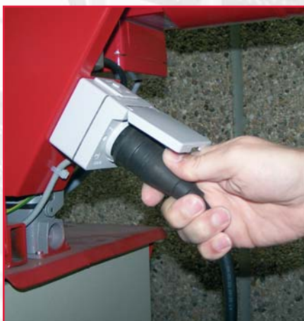
230 Volt stekker aan hijslee voor aansluiting van montagewerktuigen.
